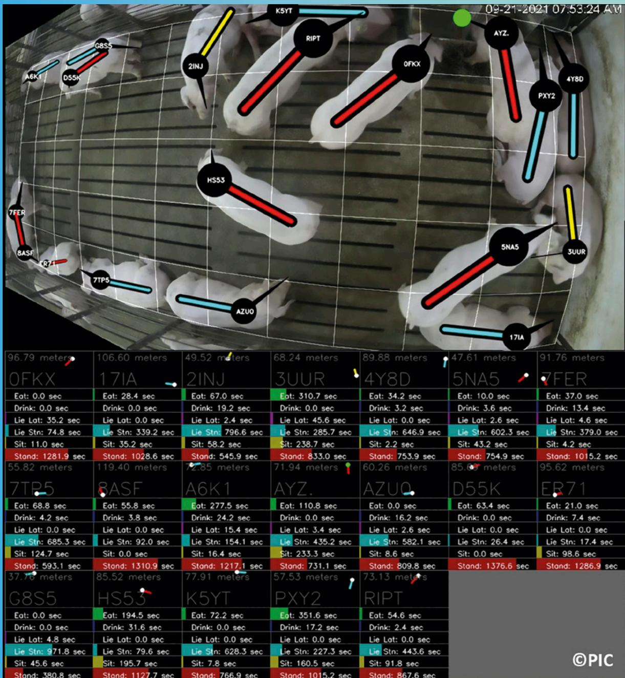
Abb. 2: Mit Hilfe des PIC Algorithmus können Tiere einer Bucht automatisiert individuell erkannt werden und die Verhaltenskategorien seitliches Liegen, Bauchlage (blau), Stehen (rot), Sitzen (gelb), Fressen (grün) und Trinken zugeordnet werden.
